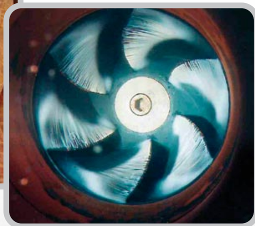
↻ Etude en cavitation avancée sur une pompe échelle 1 / Study in advanced cavitation on pump scale 1
